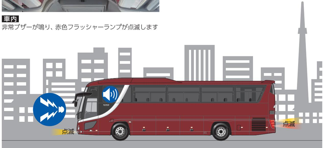
車外 ホーンが鳴り、制動灯およびハザードランプが点滅し、徐々に速度を落とし停止します
